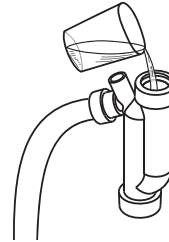
fig. 33 - Remplissage du siphon
