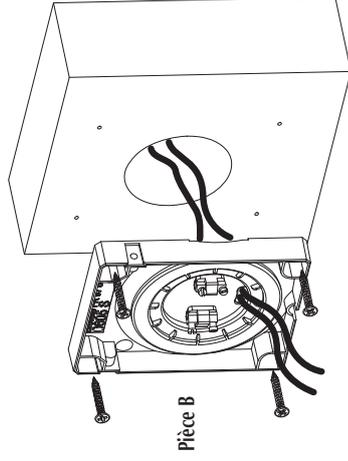
2 Fixation de la pièce B au mur à l'aide de 4 vis.
