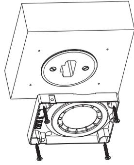
3 Fixation de la pièce B au mur à l'aide de 4 vis.
