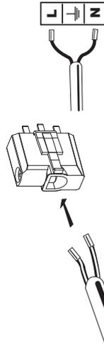
Aucune partie simple isolation ne doit dépasser du connecteur une fois celui-ci câblé.
