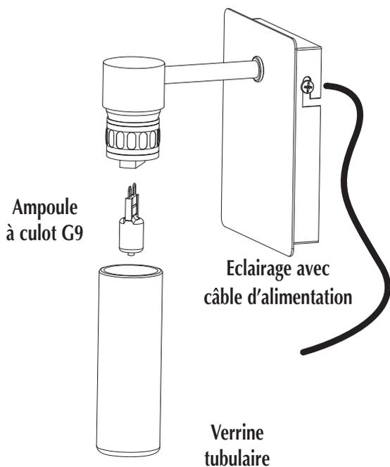
**Cet éclairage peut recevoir des ampoules à culot G9 en LED.**
