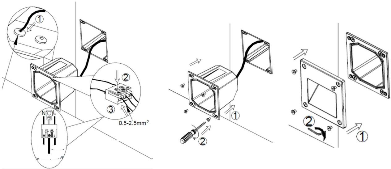
2) Si montage sur cloison bois, celle-ci ne doit pas avoir une épaisseur inférieure à 5mm. Ne pas utiliser de boîte d'encastement.
