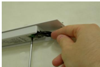
Raccorder au réseau.
