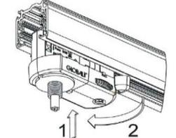
2. Insérer l'adaptateur dans le rail (1) et verrouiller (2)
