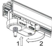
2. Insérer l'adaptateur dans le rail (1) et verrouiller (2)
