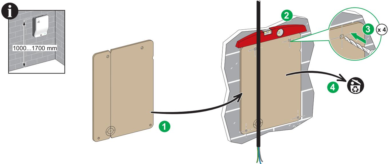
Power supply from the rear / Alimentation par l'arrière / Kabelzufuhr von der Rückseite / Strømtilførsel bakfra
