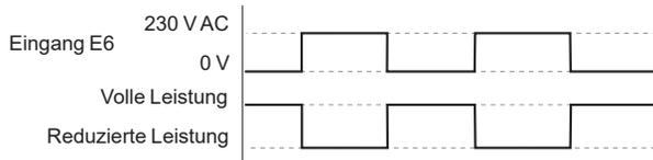
Bei 11 kW Ladestationen muss überprüft werden, ob das zu ladende Elektrofahrzeug für einen Ladestrom-Sollwert mit einer Stärke von 10 A ausgelegt ist. Andernfalls darf die Ladeleistungsbegrenzungsfunktion nicht aktiviert werden.
