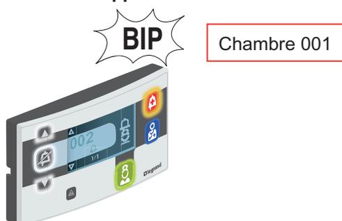
Le bloc de porte signale l'appel de la chambre (avec indication du n° de chambre sur l'afficheur) et émet une alarme sonore.
