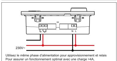
il est recommandé d'utiliser un contacteur.
