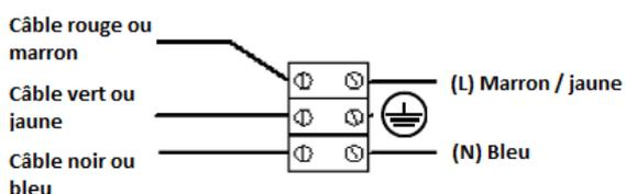
**Fig. 3b – Raccordement électrique secteur vers convertisseur (GU5,3 12V)**
