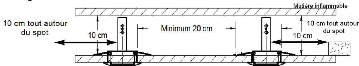
**Fig. 2 – Installation d'un encastré GU5,3 12V**
